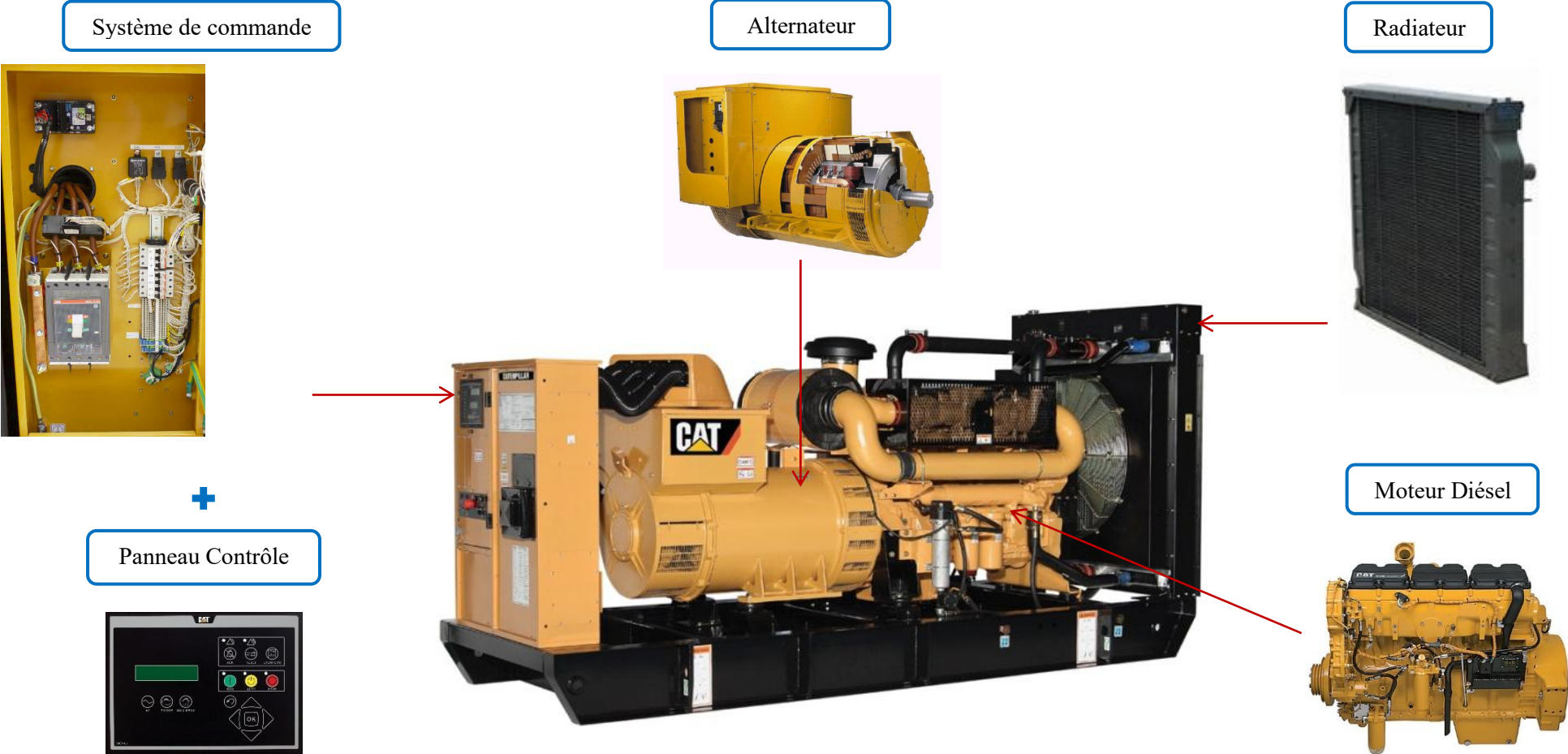
Figure 1.1 : Différentes parties du Groupe Electrogène Diesel C18-635 [1], [2]
