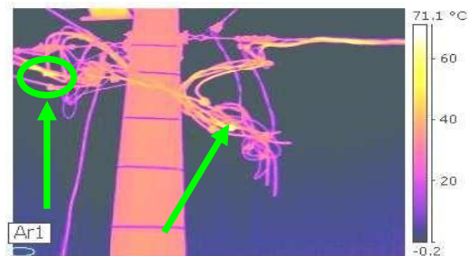
Fig. 26 : Câble BT en défaut vue par caméra infrarouge
