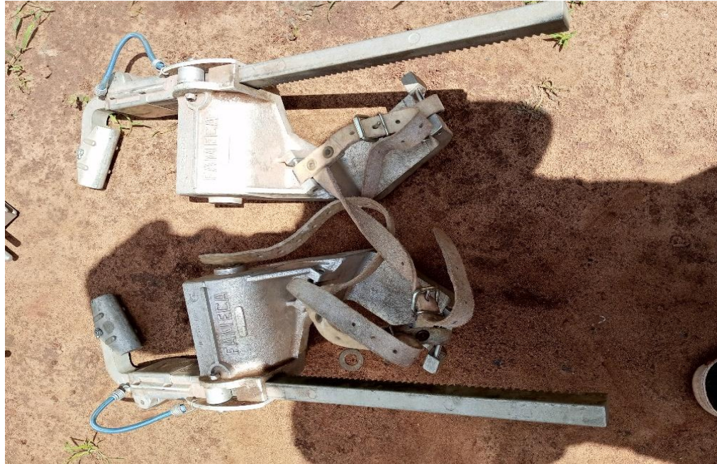
Grimpette poteau béton
