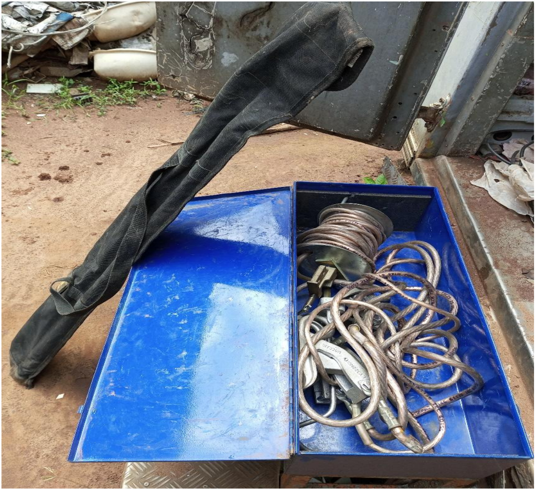
Dispositif de mise à la terre et en court-circuit(DMT-CC)
