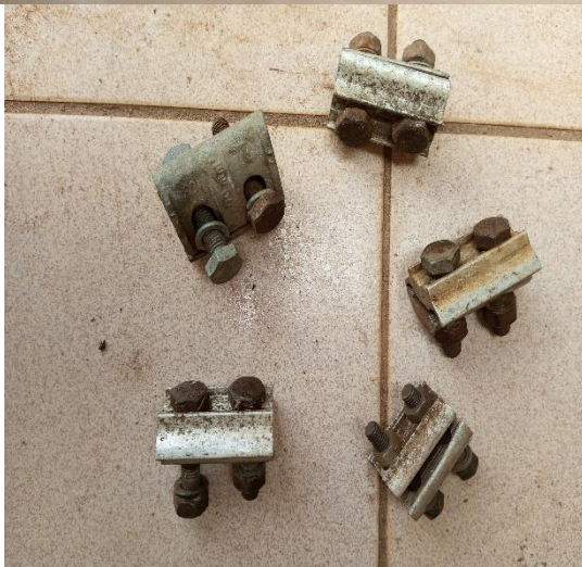
Fig1 : Connecteur de raccordement BT
