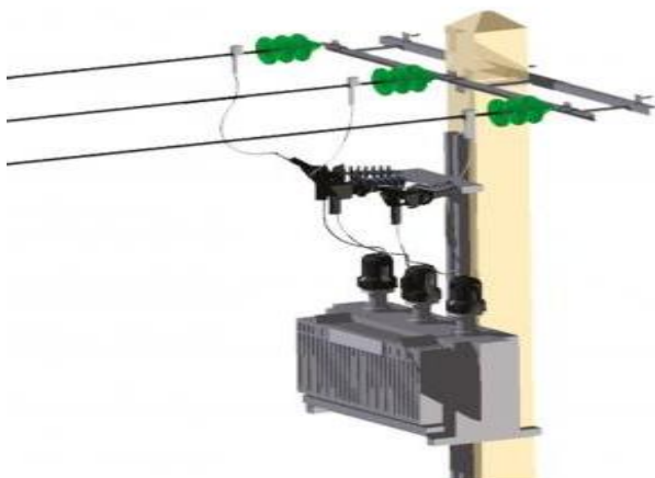
Figure 8 : Parafoudre protégeant un transformateur
